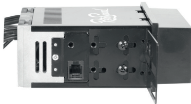
Abbildung 1 - Befestigung der Montagehalterungen
