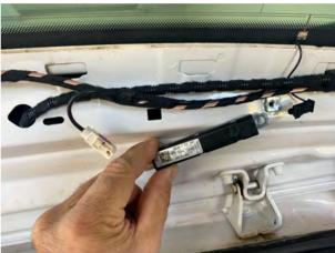
Den RTA-Antennenverstärker nun mit der Ringöse (Masse) anschrauben und 3poligen Stecker und Fakrastecker anstecken. Das Gehäuse mit dem doppelseitigen Klebeband am Blech ankleben und Kabel mit Kabelbinder befestigen.
