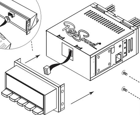
2. Nach dem Einstecken ins Display muss es an dem Grundmodul mit den vier Montage Schrauben befestigt werden.
