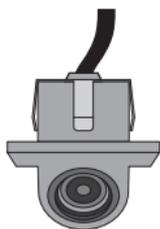
Einbau: Bohren Sie ein 22,5 mm Loch an geeigneter Stelle und pressen die Kamera vorsichtig in das Loch.
