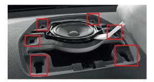
Der originale Lautsprecher ist an drei Punkten auf die Verkleidung gesteckt. Nutzen Sie gegebenenfalls einen Plastikkeil zum heraushebeln des Lautsprechers. Nutzen Sie zum Entriegeln der Anschlussstecker entweder einen schmalen Schraubenzieher oder eine Büroklammer.
