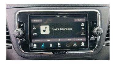
Anschuss am 52Pin Stecker der Daily Hi-Connect Head-Unit bzw. Ucon7 Daiichi Radio. Rückfahrkamera muss NTSC sein.
