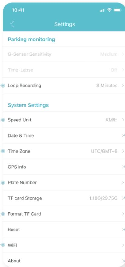
Die Loop-Aufnahme bestimmt die Länge der Videosegmente. Dies erleichtert das Auffinden bestimmter Ereignisse bei Bedarf.
