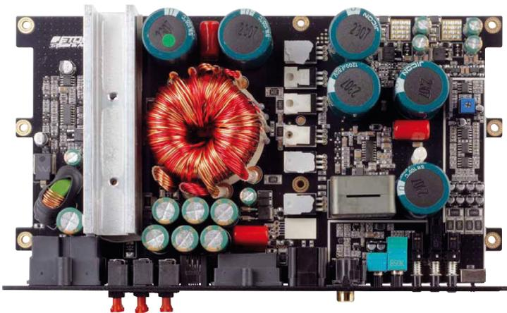
**Eigenständiges Layout mit Kühlkörper über den Netzteilbauteilen, während die Endtransistoren zur Kühlung ans Gussgehäuse andocken**
