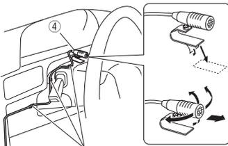
Befestigen Sie das Kabel mit handelsüblichem Klebeband.
