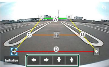
Stellen Sie sicher, dass die Linien **(A)** und **(B)** horizontal parallel zueinander stehen und dass die Linien **(C)** und **(D)** gleich lang sind.
