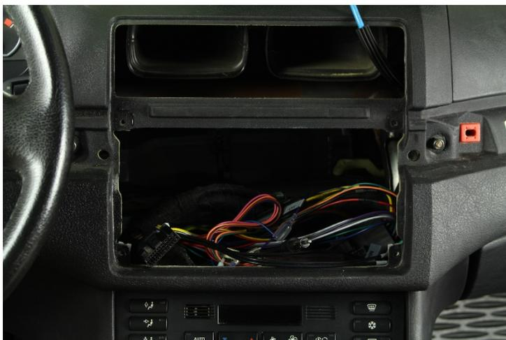
13. Verbinden Sie das jeweilige Hauptanschlusskabel (Nr. 11/12) des Radical-Geräts (Nr. 1) mit dem Stecker des Fahrzeugs und schließen Sie den Verriegelungsmechanismus des Steckers. Verbinden Sie anschließend das CAN-Bus Interface (Nr. 13) mit dem Hauptanschlusskabel. Verbinden Sie alle zuvor in den Radioschacht verlegten Kabel und die originalen Antennenkabel mit dem Radical-Gerät (Nr. 1).
