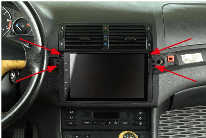
15. Positionieren Sie die Lüftungsschlitze wieder an ihren ursprünglichen Platz und verschrauben Sie anschließend die vier Befestigungspunkte mit den originalen Kreuzschrauben.
