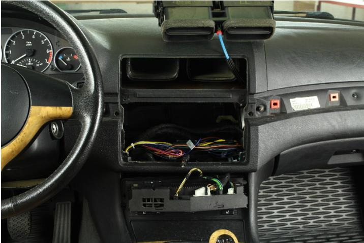
10. Verlegen Sie die Anschlüsse des Klimabedienteils durch die Öffnung des zuvor entfernten Ablagefachs und verbinden Sie die Anschlüsse mit dem Klimabedienteil.
