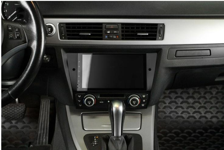
9. Verbinden Sie die Stecker der Mittelkonsole mit dem Klimabedienteil und verriegeln Sie beide Stecker. Führen Sie das Klimabedienteil in die Führung ein und drücken Sie es fest.
