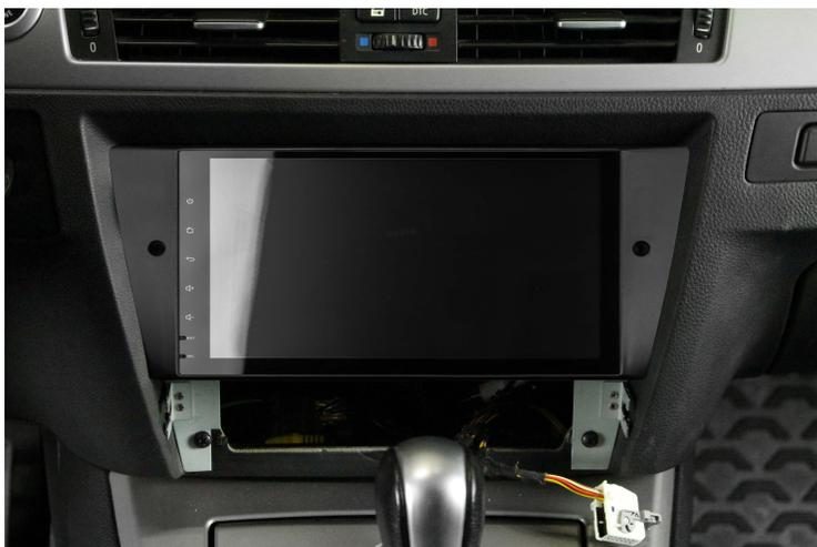
8. Montieren Sie die beiliegende Montagerahmen aus Metall (Nr. 17/18) mit den zwei Originalschrauben im Montageschacht. Verbinden Sie alle zuvor in den Radioschacht verlegten Kabel und die originalen Antennenkabel mit dem Radical-Gerät (Nr. 1). Führen Sie den R-C11BM2 in den Schacht ein und befestigen Sie das Gerät mit den zwei im Set Umfang enthaltenen Schrauben.
