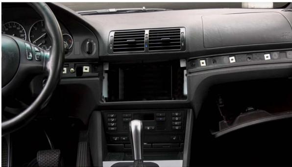
1. Nehmen Sie nun die mitgelieferte Montagehalterung (Nr. 15) und setzen sie passend in den Radioschacht. Verschrauben Sie diese fest mit dem Kreuzschraubendreher auf der Innenseite des Schachtes.
