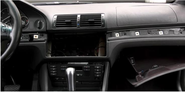
5. Um die metallische Radiohalterung aus dem Schacht entfernen zu können, müssen Sie nun alle mit der Mittelkonsole verbundenen Schrauben, links wie rechts im Handschuhfach, lösen. Nur dann können Sie die Halterung aus dem Schacht herausnehmen, da diese etwas in den Umgebungsraum hineinragt. Dafür müssen Sie die Mittelkonsole etwas in den Fahrgastraum herausziehen.
