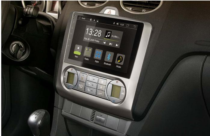
4. Verlegen Sie die diversen Anschlusskabel des Radical-Geräts sorgfältig im unteren Bereich der Radioschachts. Schieben Sie anschliessend das Radical-Gerät vorsichtig und mit dosierter Kraftaufwendung zurück in den Radioschacht. Drücken Sie den R-C10FD2 soweit nach innen, bis Sie hören wie die Verriegelung einklickt.
