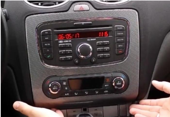
1. Ziehen Sie den Plastikrahmen an der unteren Seite leicht nach vorne, um sie von der Multimediabedieneinheit zu lösen.
