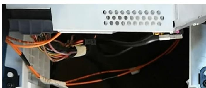
7. Ziehen Sie das Originalradio vorsichtig und mit der notwendigen Geschwindigkeit aus dem Schacht. Achten Sie dabei darauf, dass Sie die Kabel nicht beschädigen. Entfernen Sie die Kabel einzeln und vorsichtig, achten Sie weiter darauf, dass die Kabel nicht zurück in den Schacht fallen.
