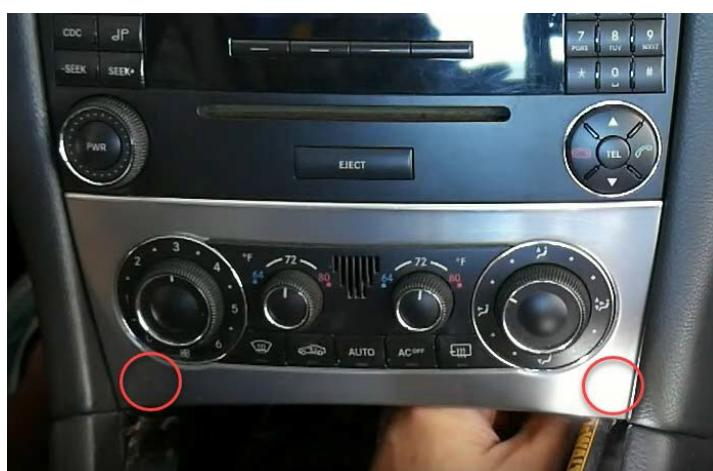
3. Nun müssen Sie die Klammern für die Blende in der Mittelkonsole lösen. Hierzu benötigen Sie einen dünnen langen Schlitzschraubenzieher. Nachdem Sie die Klammern gelöst haben, können Sie alle Stecker von den Bedienelementen abziehen.
