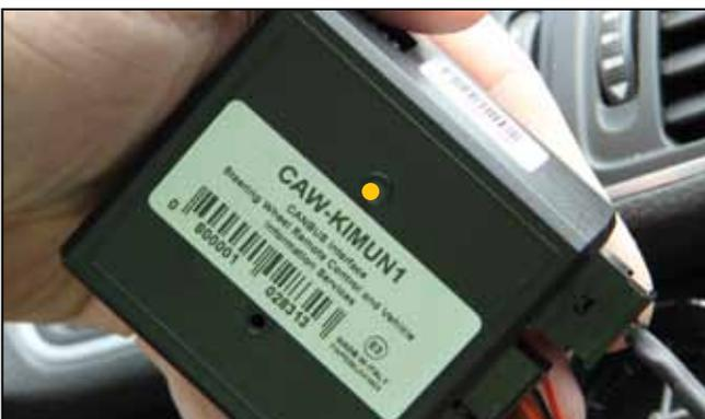
Zunächst leuchtet die Adapter-LED gelb auf und blinkt anschließend ein oder mehrmals in rot.
