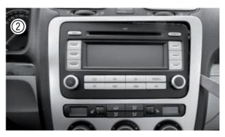
Hebeln Sie von rechts beginnend vorsichtig den das Radio umgebenden Plastikrahmen aus seiner gesteckten Verankerung. Für diesen Schritt benötigen Sie ein entsprechendes Werkzeug zur Entfernung von Kunststoff-Paneelen.
