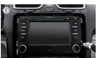
Werstauen Sie die Kabel in den Randbereichen und schieben Sie das Z-E2014M in den Schacht. Vermeiden Sie zuviel mechanischen Druck auf die Front. Es könnten Stecker abbrechen oder Kabel gequetscht werden. Schrauben Sie das Z-E2014M mit den vier Originalschrauben wieder fest.
