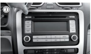
Fahren Sie einmal gegen den Uhrzeigersinn mit dem Lösewerkzeug um den Rahmen. Der Zierrahmen sollte sich nun vollständig von der Konsole ablösen lassen.
