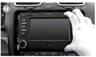
Stecken Sie den Quadlockstecker vom vorbereiteten Z-E2014M Gerät an das Gegenstück im Fahrzeug an und schliessen Sie die Verriegelung. Verbinden Sie die den Fakrastecker vom GPS Antennenkabel mit dem Gerät und auch das Kabel vom externen Mikro, wenn dieses montiert wurde.
