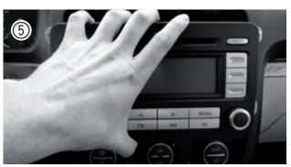
Ziehen Sie das VW Originalgerät langsam und vorsichtig dem Schacht. Stecken Sie alle Kabel an der Gerätrückseite ab. Legen Sie das Gerät zur Seite um es vor Beschädigungen zu schützen.
