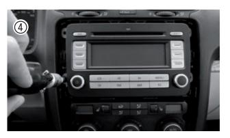
Lösen und entfernen Sie die vier Torx-Schrauben vom VW Originalgerät.
