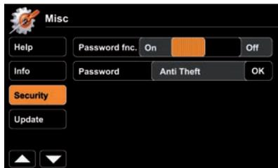
Aktivieren Sie die Passwortfunktion, um das Gerät bei Diebstahl zu schützen. Die Diebstahlfunktion ist CAN-Bus basiert und sperrt das Gerät, wenn es in ein anderes Fahrzeug eingebaut wird. Es besteht die Möglichkeit, ein eigenes vierstelliges Passwort einzugeben. Im Auslieferungszustand lautet das Passwort "0000".
